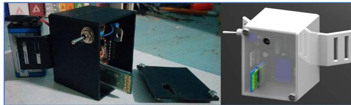
Fig. 11. Sistema embebido del sensor con su contenedor: derecha, diseño renderizado; izquierda, producto final.
